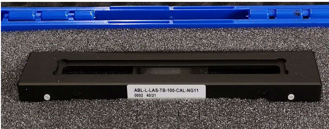
Abb.: 2 Kalibrieraufsatz ABL-L-LAS-TB100-CAL-NG11
